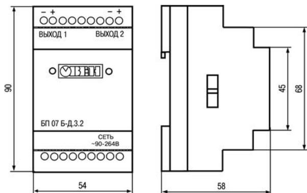
**Рисунок 3.1 – Габаритные размеры блока питания БП07Б-Д3.2-х**
