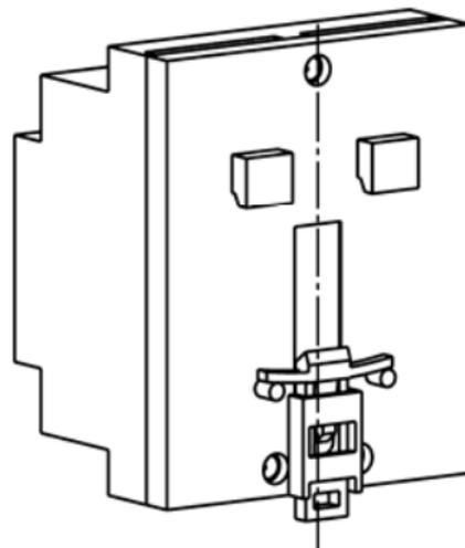
**Рисунок А.2 – Корпус Д для крепления на DIN-рейку**
